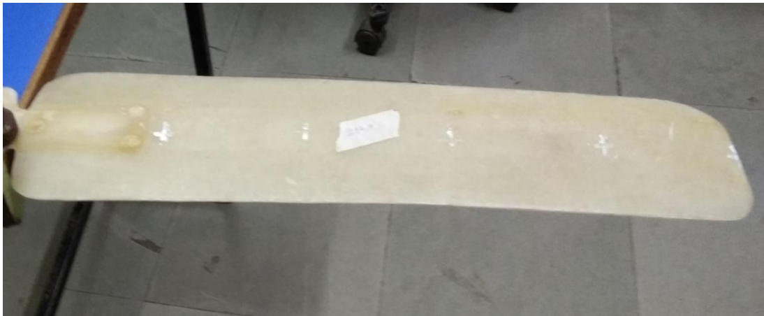
Figure.13. Composite material fan Blade
